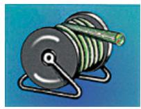
**2** No coloque o instale el cable en lugares con rebabas o filos que puedan dañarlo. No utilice ángulos pronunciados, cuando sea necesario darle la curvatura durante su instalación.
